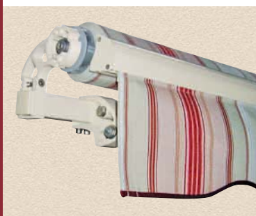
Tube carré autoporteur, section 40 x 40 x 1,50 en acier laqué. Support de tube enrouleur et support de pose en aluminium extrudé.
